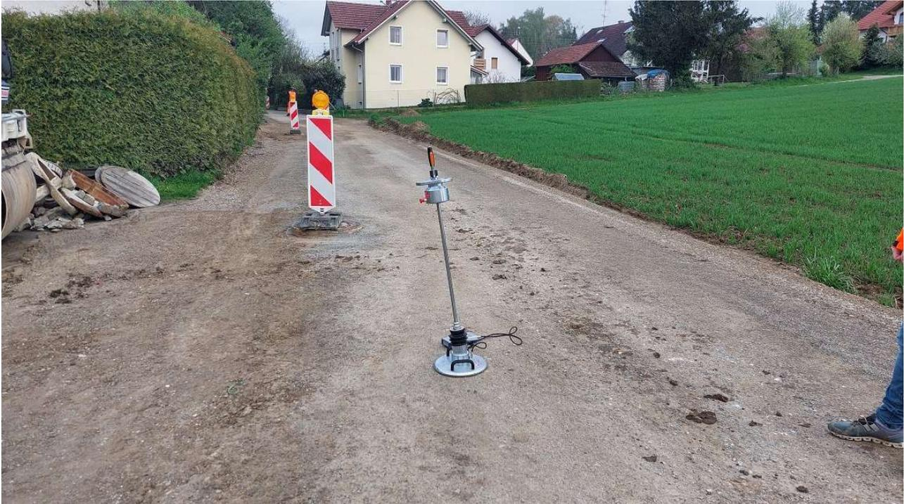
Lastplattendruckversuch mit angelegtem Schacht im Hintergrund
